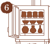
本焼 窯詰めし、約12～168時間焼き、3～30日ほど冷ます。
