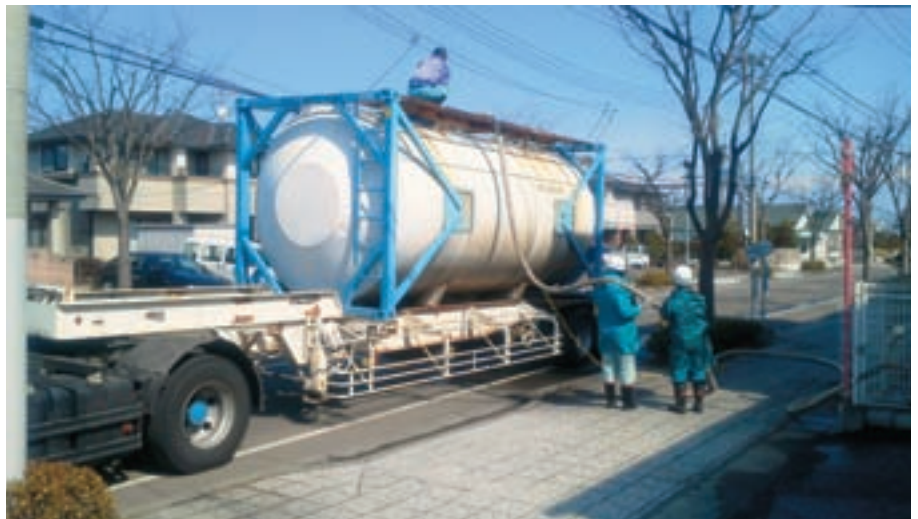
消火栓からの給水（大和町上下水道課）
