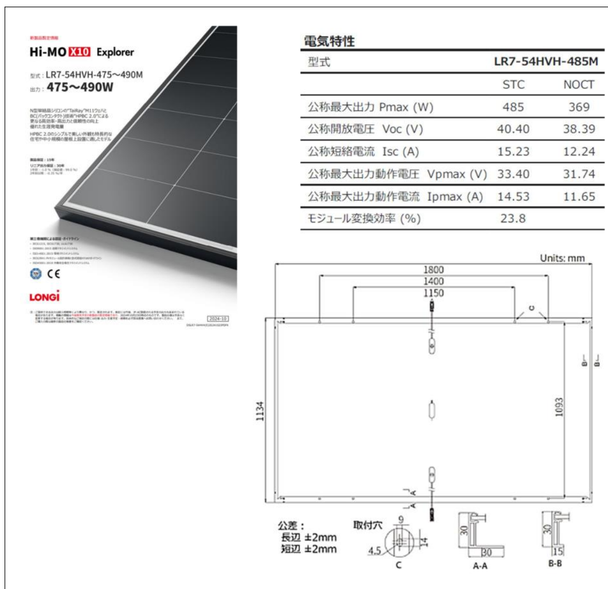
図. 2.3-1 設置可能性評価に用いたガラス型のパネル（475～490W）の概要
